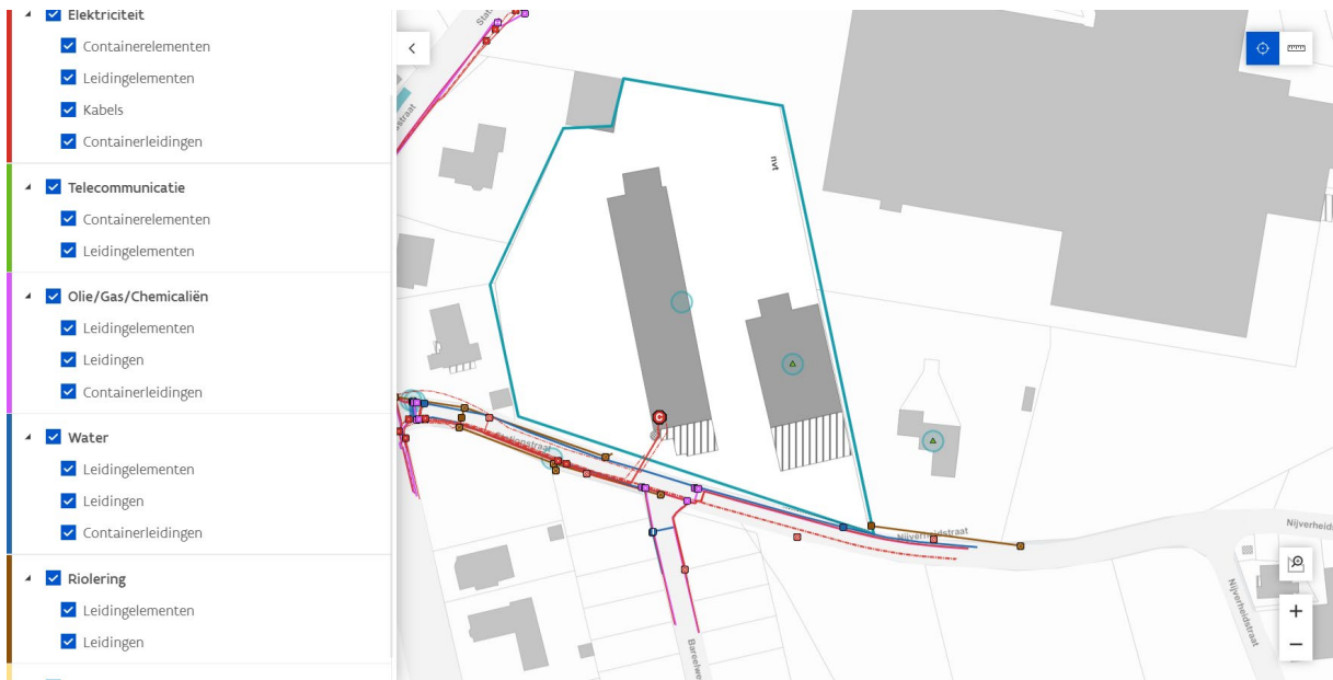
Figuur Ligging nutsleidingen Stationsstraat 179 Oostrozebeke volgens KLIP
