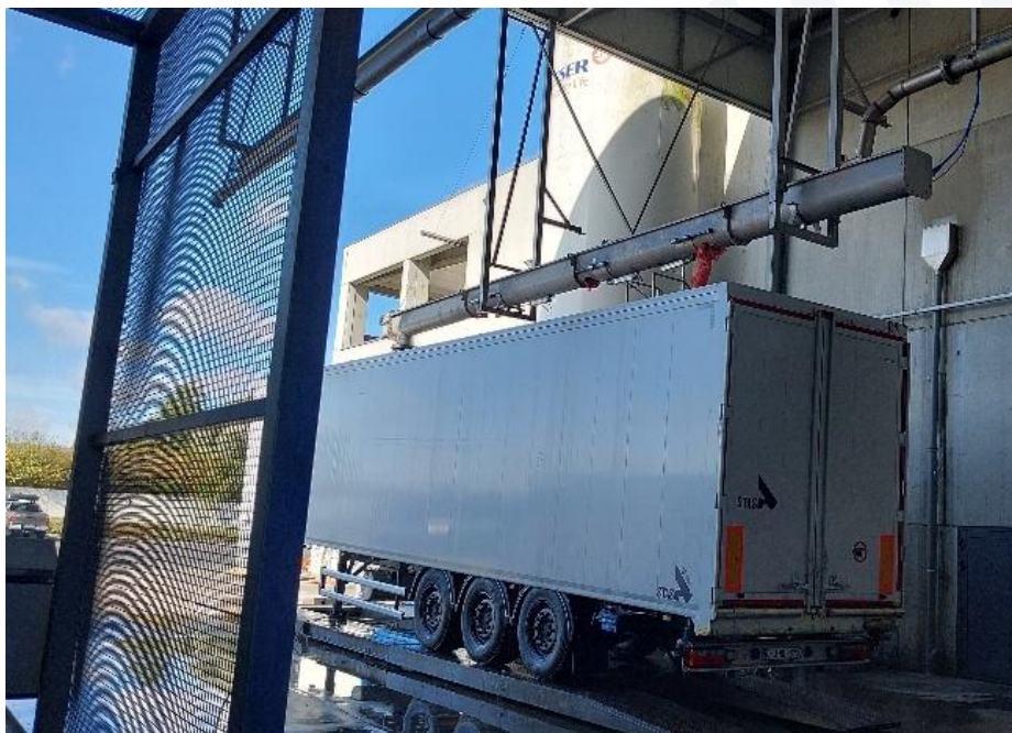
Figuur 3: Laadplaats met aanvoer van vlees via vijzel
